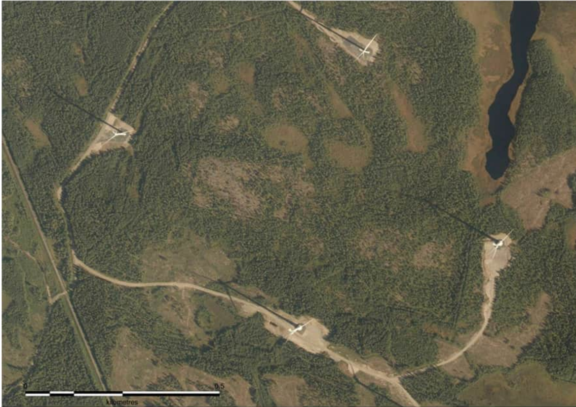
Kuva 82. Esimerkkikuva toiminnassa olevasta tuulivoimapuistosta. Tuulivoimaloita varten on rakennettu huoltotiet ja nostokentät. Tuulivoimaloiden ympäristössä ja välialueilla aikaisempi maankäyttö on säilynyt ennallaan.
